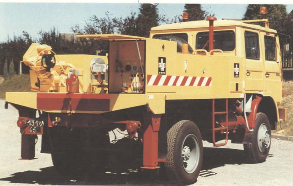
TH 600 sur RVI JE13 4x4 double cabine 7places version export PTAC: 13 T, Poids à vide: 6,9 T, Emp.: 3,4 m, P. à F. AR: 1,475 m
